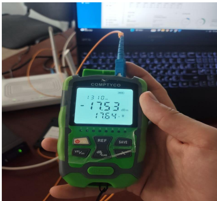
3.2-сурет – ONT-ны OLT-ге қосу кезінде оптикалық қуат деңгейін өлшеу
